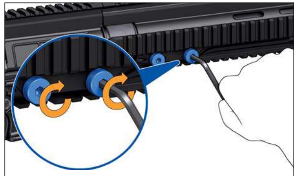
Abb. 47a: Halteschraube für Handschutz festziehen
