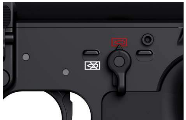
Abb. 13b: Stellung "Einzelfeuer"
