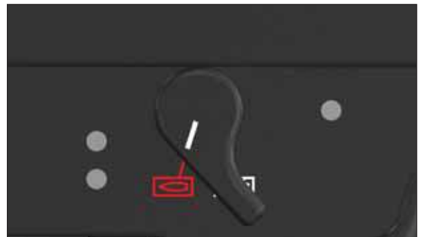
Abb. 13b: Stellung "Einzelfeuer"
